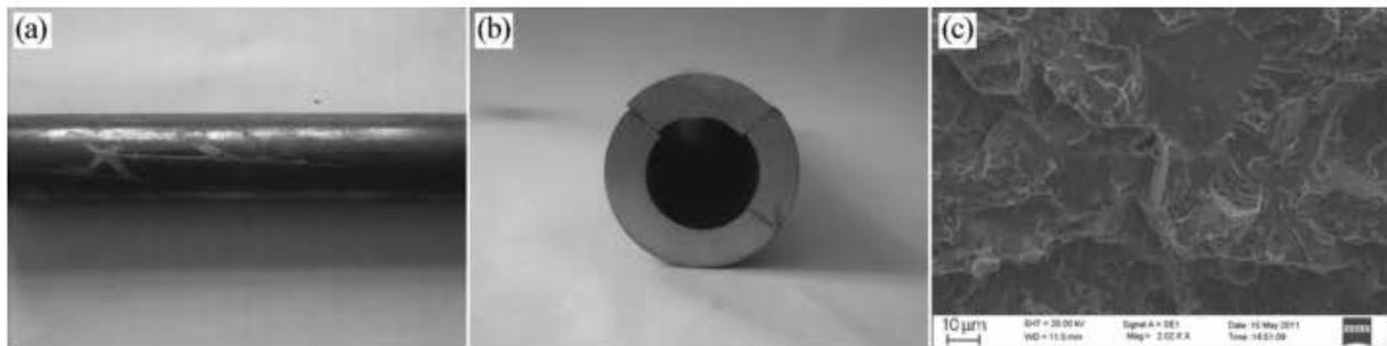
图 1 45 钢管开裂处宏观 (a, b) 与微观形貌 (c)
