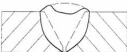
图3 焊缝收尾的弧坑
