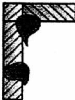
图5 焊瘤缺陷图
